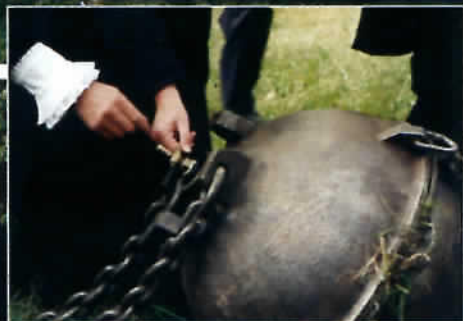
◁△ Acht Pferde auf jeder Seite der Halbkugeln schafften es nicht, das Vakuum zu überwinden und die Kugeln auseinanderzureißen. Ein kleiner Dreh am Ventil, die Luft strömt ein, und die Kugeln fallen von selbst auseinander
